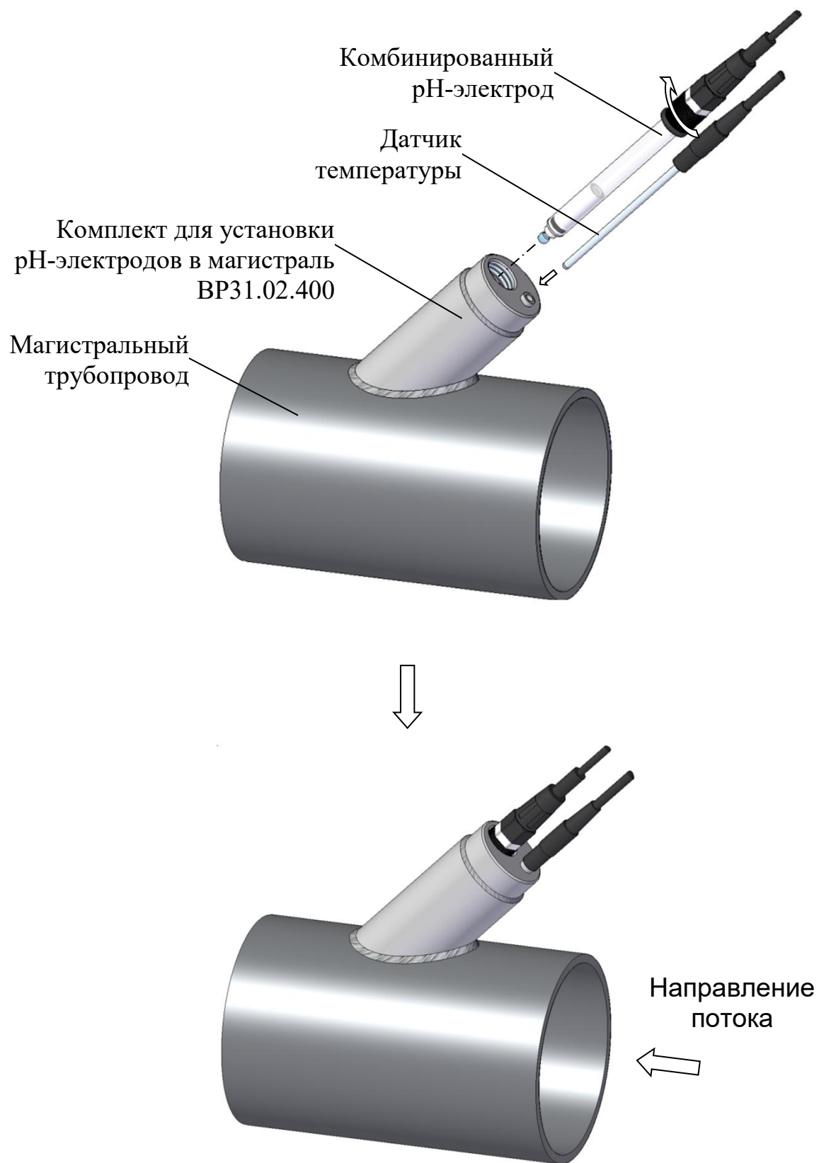
Рисунок 2.11 – Расположение комбинированного рН-электрода и датчика температуры для проведения измерений в магистральном трубопроводе
