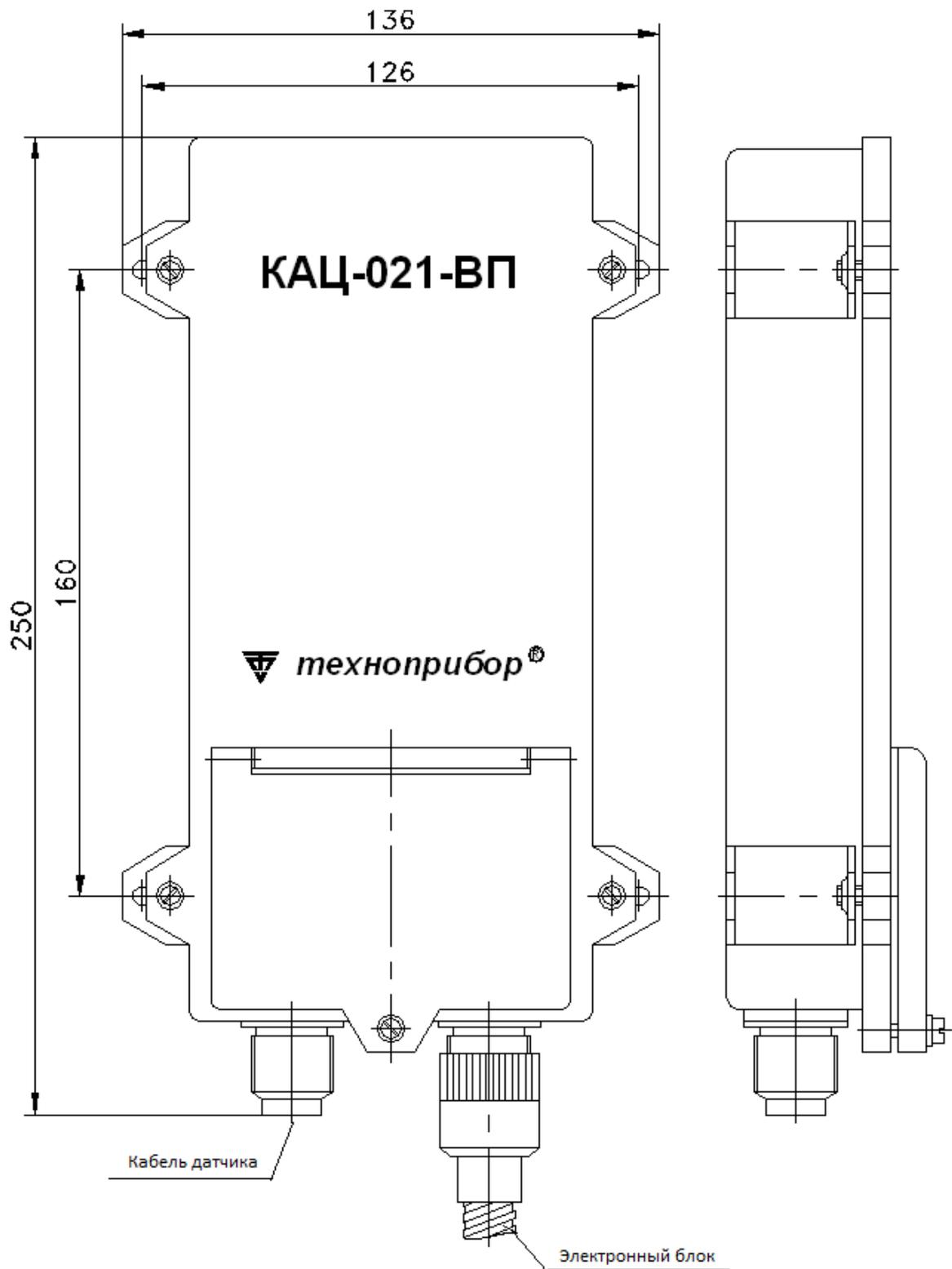
**Рисунок 2. Вторичный преобразователь.**
