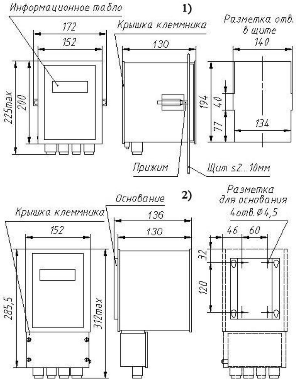
**Рисунок 3. Измерительный блок IP-65:**
