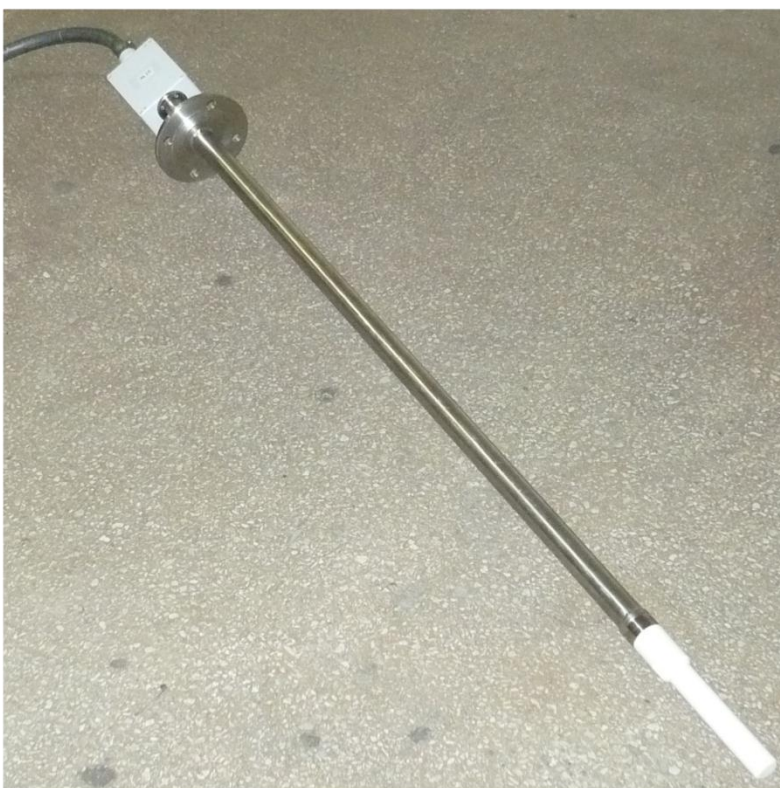
Рисунок Б.11 – Внешний вид первичного преобразователя КС-1М-4 в погружном исполнении на металлической штанге
