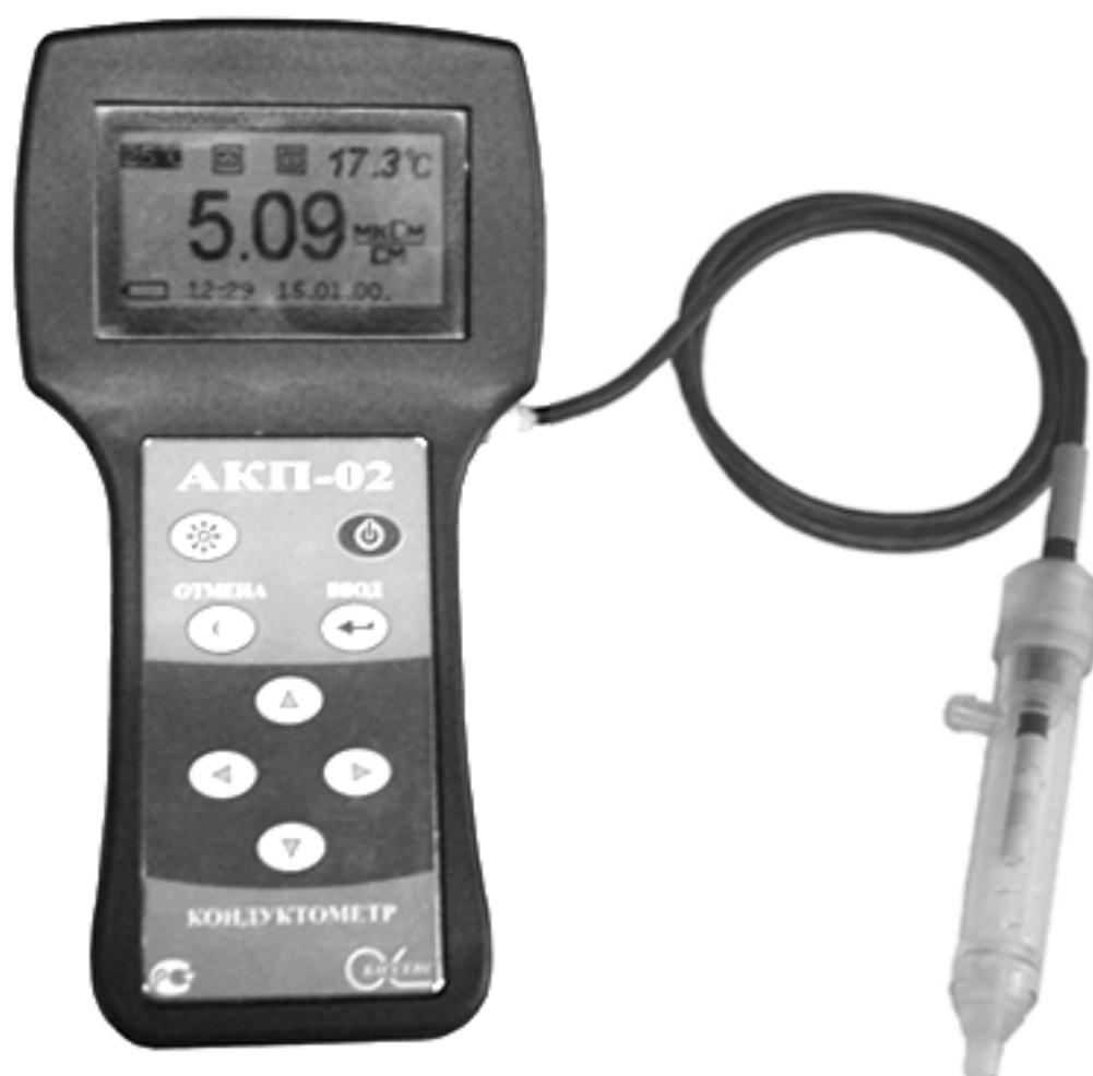
Рис. 1-1 Внешний вид анализатора кондуктометрического АКП – 02
