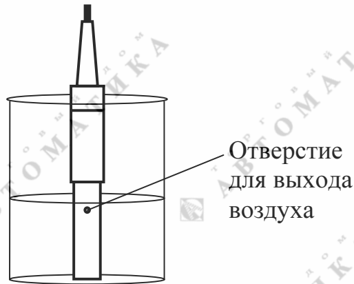
Рисунок 2.1 – Проведение измерений погружным методом
