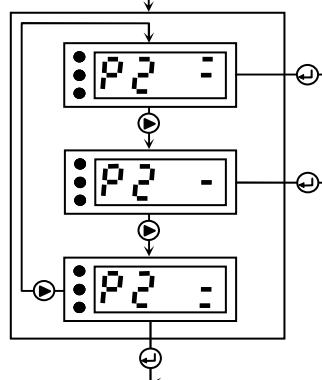
Реле **P2** будет включено, когда измеренное значение УЭП (концентрации) превысит значение **E2+П2**, и выключится, когда измеренное значение будет меньше **E2-П2**. Здесь **E2** – численное значение второй уставки по УЭП (концентрации), **П2** – численное значение порога срабатывания реле **P2**.
