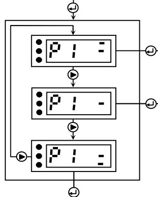
Реле **P1** будет включено, когда измеренное значение УЭП (концентрации) превысит **E1+П1**, и выключится, когда измеренное значение будет меньше **E1-П1**. Здесь **E1** – численное значение первой уставки по УЭП (концентрации), **П1** – численное значение порога срабатывания реле **P1**.
