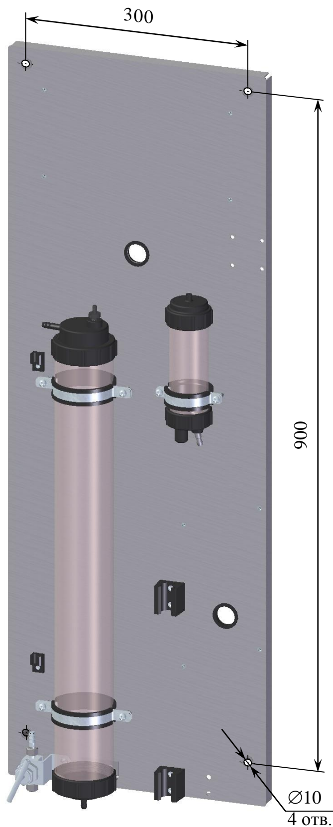
Рисунок 3.1 – Расположение и размер отверстий для крепления гидропанели
