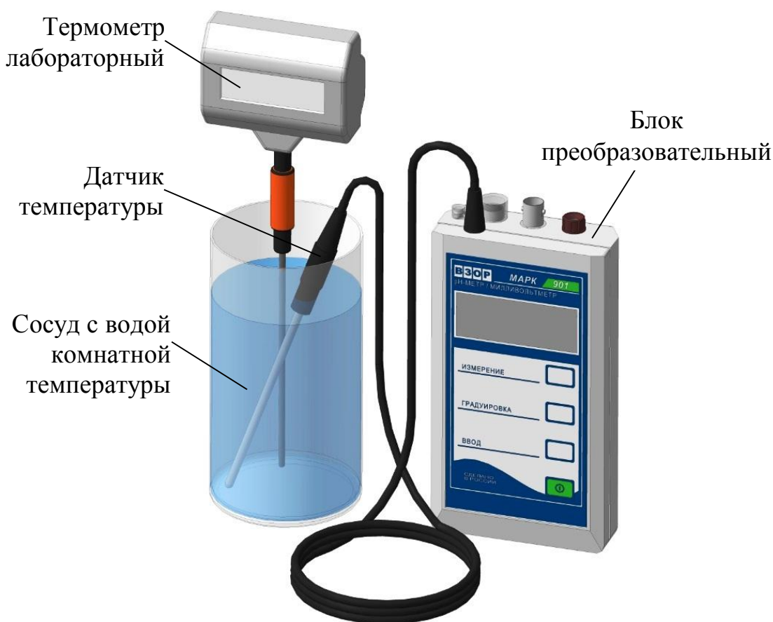
Рисунок 3.2 – Проверка показаний по температуре
