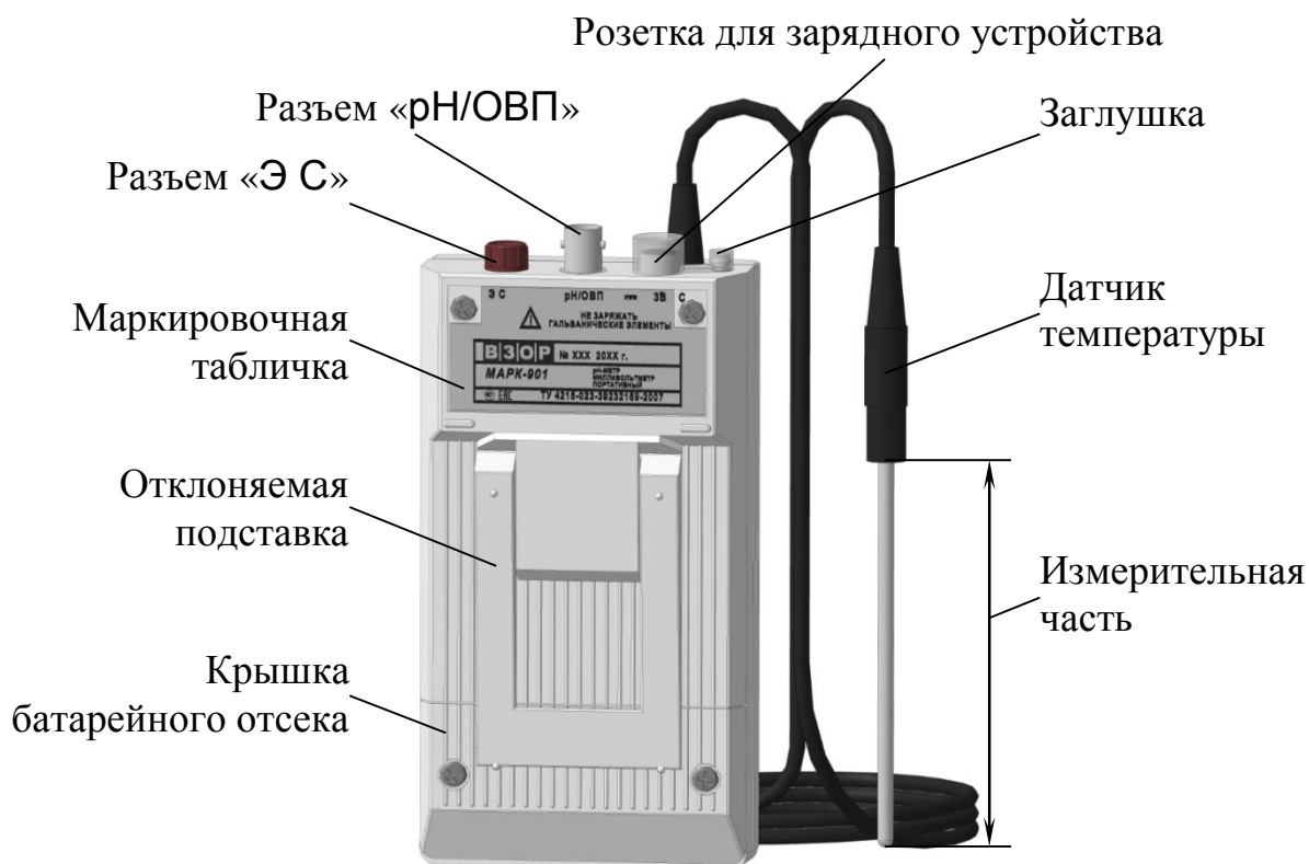
Рисунок 1.2 – Блок преобразовательный (вид сзади)
