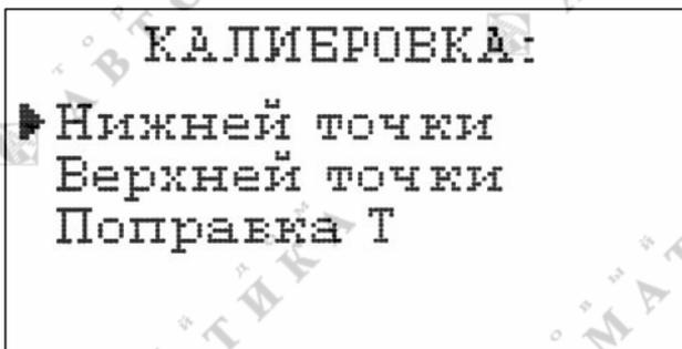
Погрузите сенсор и образцовый термометр в термостатируемый стакан с температурой нижней отметки шкалы: 5+1°C или в лунку в стакане со льдом. Дождитесь установления показаний термометра (см. Рис. П4-2.) и нажмите «ВВОД».
