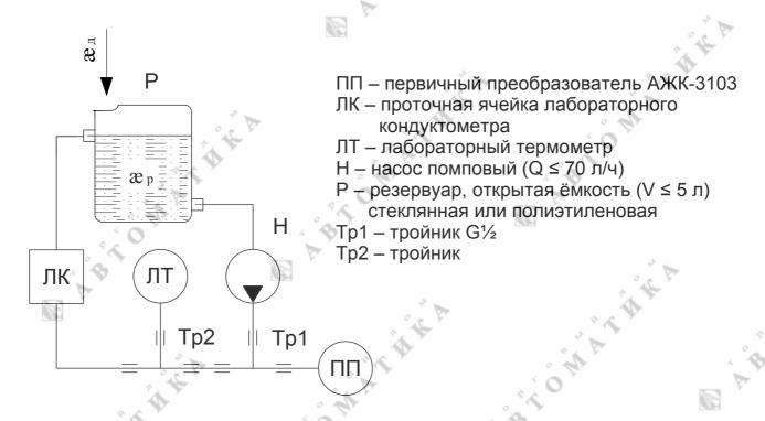
Приведена структурная схема стенда настройки и калибровки АЖК-3103 на протоке.
