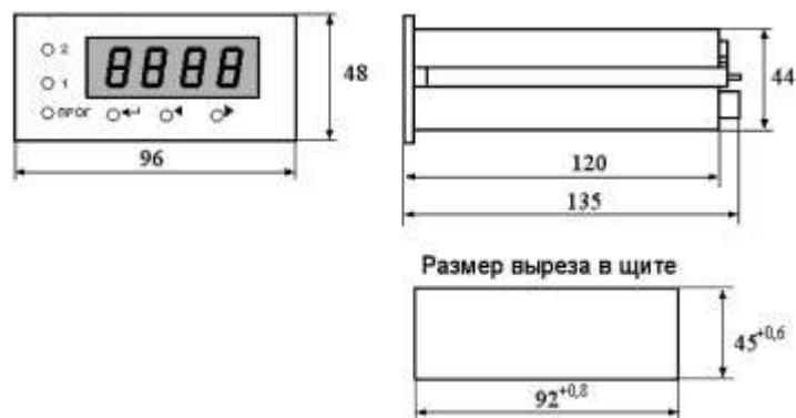
Рис. 3. Габаритные и монтажные размеры измерительного прибора рН-4121
